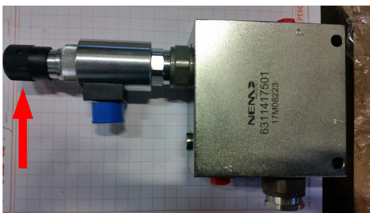
Figura 2 - Otturatore
