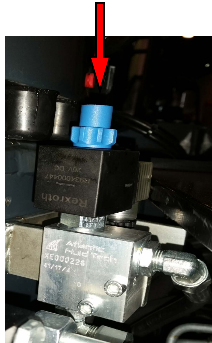
Figura 1 – valvola d'emergenza (NUOVA)
